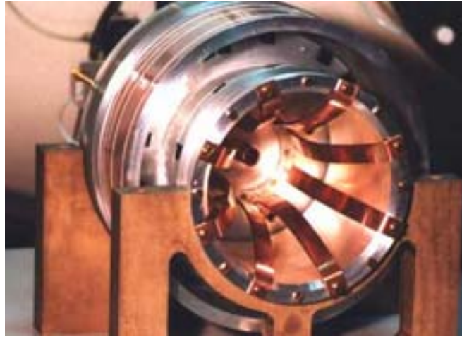
Εικόνα 5. Το πρωτότυπο μαγνητοπλάσμοδυναμικού πυραυλοκινητήρα της εταιρείας Alta.
