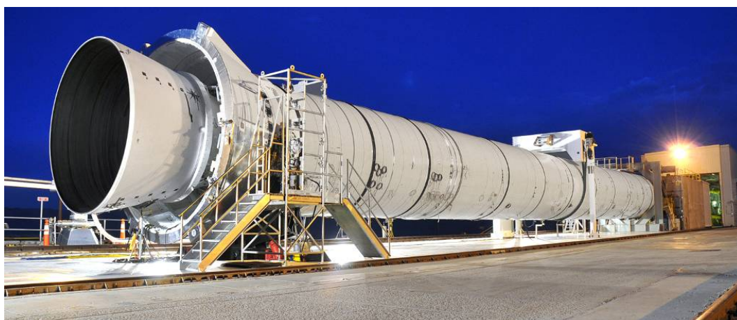
Εικόνα 1. Δοκιμή του πρωτότυπου DM-2 πυραυλικού κινητήρα προώθησης στερεών καυσίμων 5 σταδίων της NASA (Σεπτέμβριος 2010).
