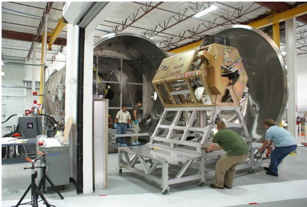
Εικόνα 7. Κατασκευή του πρωτότυπου VX-200 πυραυλοκινητήρα μαγνητοπλάσματος μεταβλητής ειδικής ώθησης (VASIMR) της εταιρείας Ad Astra.
