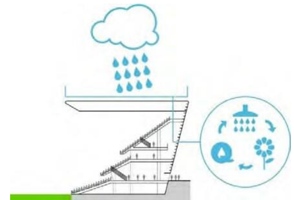
Діаграма, що ілюструє збір дощової води з даху стадіону
