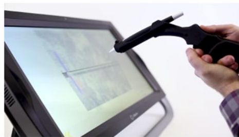
スタイラス応用例：ホルダーに装着し溶接の訓練に使用
